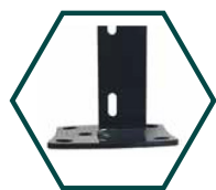
Platine - 120x120mm : panneau jusqu'à 1m73. Nécessite 4 vis M8x16 (non fournies).
